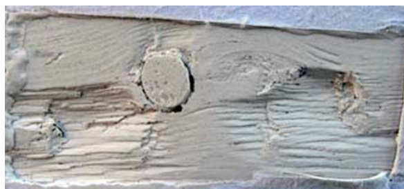
Urslag runt kvist (gipsavgjutning).
