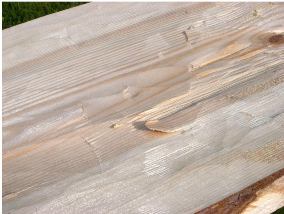
Nyttillverkad skave och verktygsspår.
