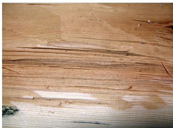
Urflisningar efter spräckning.
