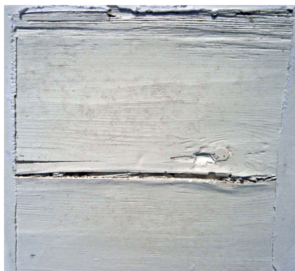
Urrivning i den stående veden och små urslag vid kvist, (gipsavgjutning).
