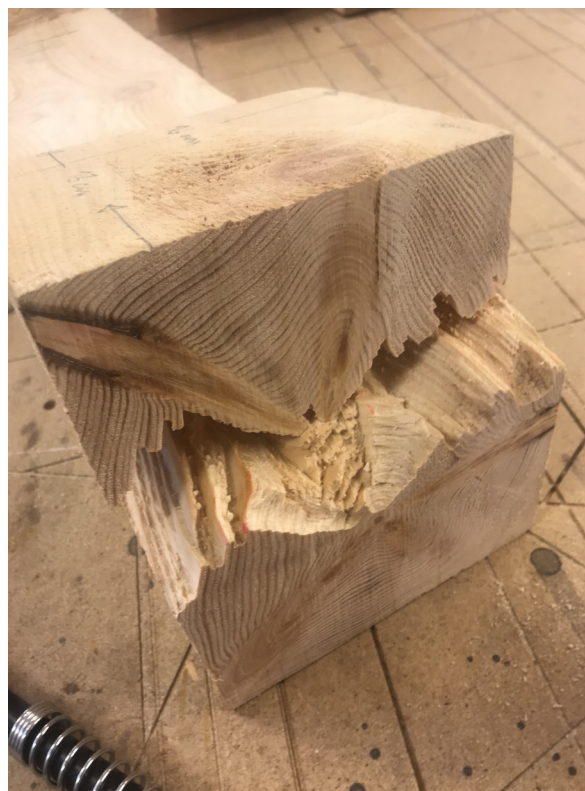
Fig. 17. Eit betahovud laga etter tradisjonelle mål har gått i brot.
