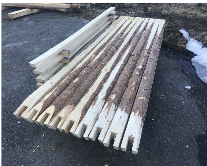
Fig. 24. Sperrene på sabruket og sperrene ferdig tillaga.
